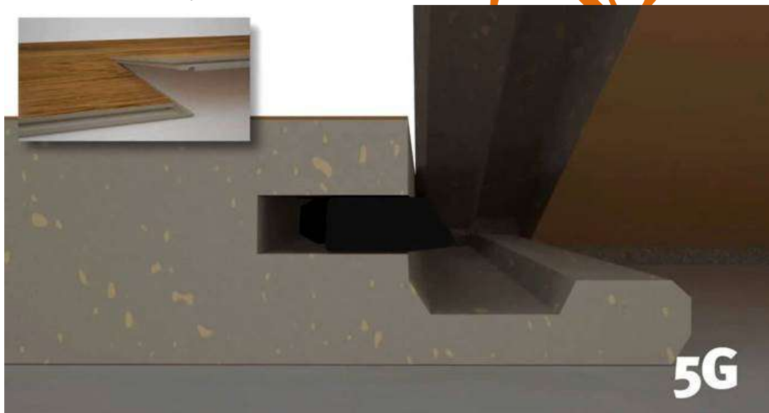
Рисунок 15. «5G» технологии замков ламината
