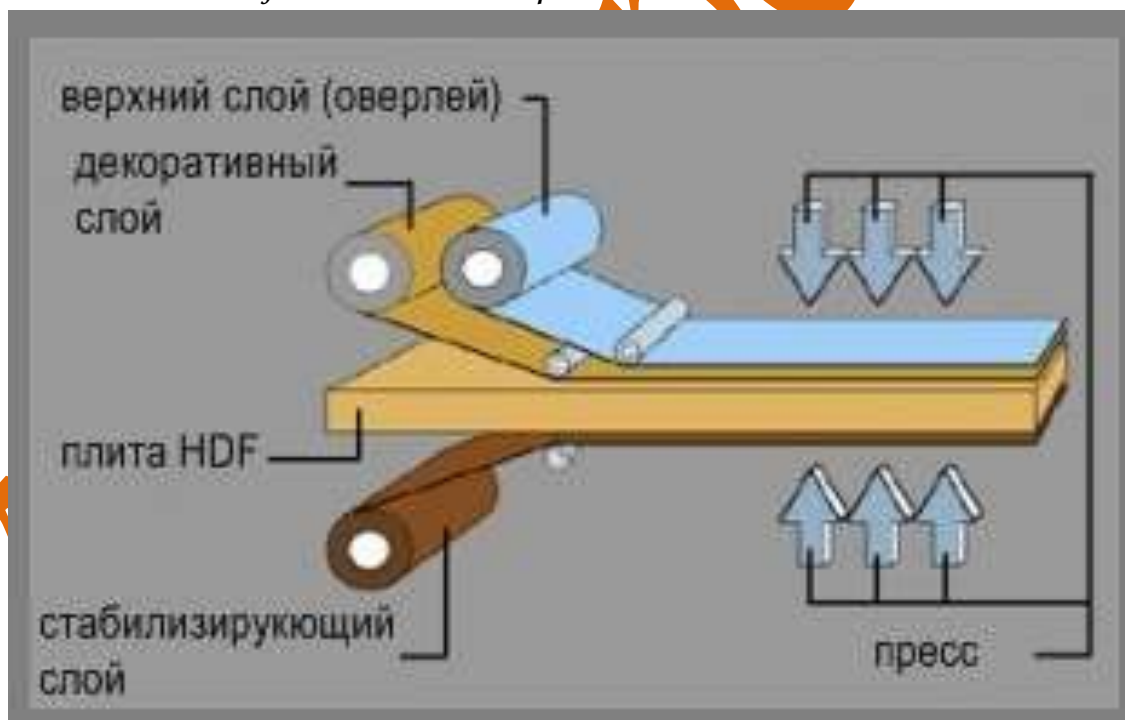
Рисунок 8. Технология производства ламината DPL
